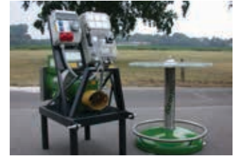
Die Instrumente des Kemper-Zapfwellenaggregats sind vom Schlepper aus gut einsehbar: links diverse Steckdosen und die Hauseinspeisung, rechts Zeigerinstrumente für Strom, Spannung und Frequenzen sowie darunter der Generator-Leistungsschalter (Quelle: Kemper)
