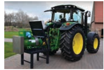
Das über einen Schlepper angetriebene 150 kVA-Notstromaggregat von Kemper sichert bei Stromausfall den landwirtschaftlichen Betrieb mit leistungsstarken Stromabnehmern (Quelle: Kemper)
